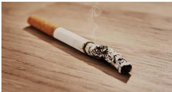
Uno de los ensayos térmicos a los que han sido sometidos los laminados de FLINT es la resistencia al cigarrillo. Tras colocar un encendido sobre la superficie en posición plana, no deja marca alguna después de consumirse 2 cm. **No aparecen ampollas ni decoloraciones** por esta causa. Estos ensayos están detallados en las Normas EN-13329 y EN-438.
